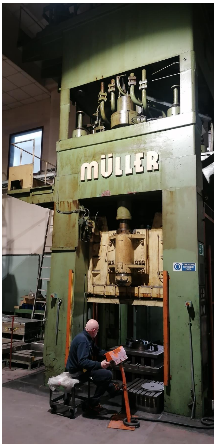
N.1 PRESSA IDRAULICA MULLER 600 Ton, passaggio tra i montanti 1750x1300
